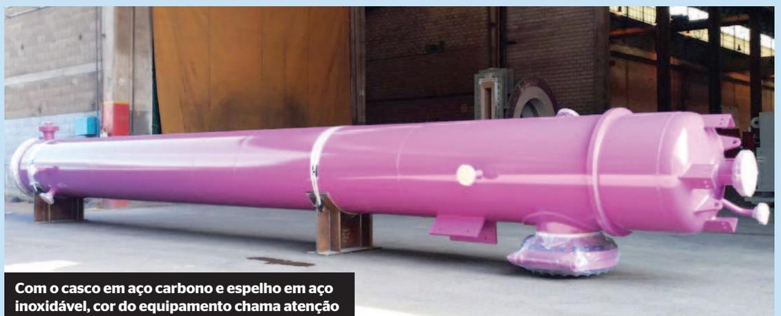
Com o casco em aço carbono e espelho em aço inoxidável, cor do equipamento chama atenção
