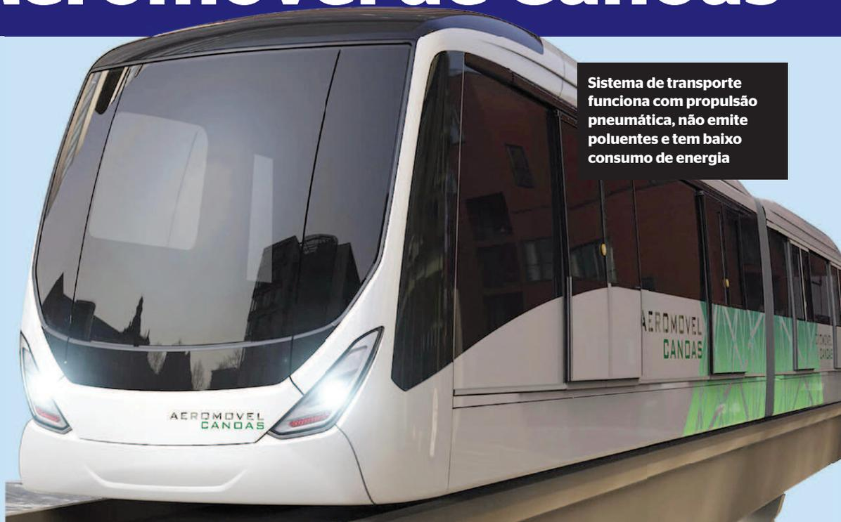
Sistema de transporte funciona com propulsão pneumática, não emite poluentes e tem baixo consumo de energia
